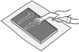
Entfernen Sie den Staub vom **GERUCHSNEUTRALISATIONSFILTER**.
