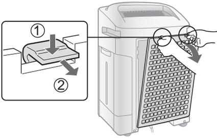
Entfernen Sie die Rückwand.
