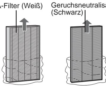
Entnehmen Sie die Filter aus dem Plastikbeutel.
