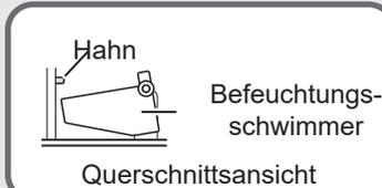
2. Setzen Sie den Befeuchtungsschwimmer in das Loch ein.
