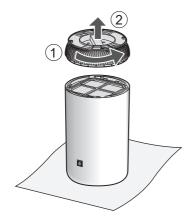
3 Entfernen Sie den Vorfilter (1) und den integrierten Staubauffang- und Geruchsfilter (2).
