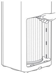
Öffnen Sie die Filterfachabdeckung und ziehen Sie den Bügel horizontal heraus, um den Filter zu entfernen.
