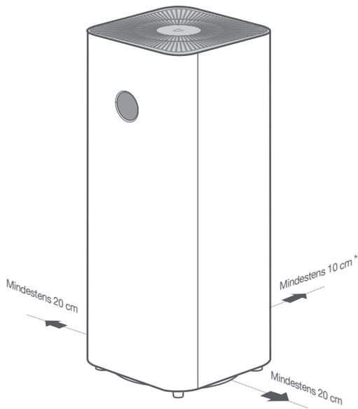
\* Der Luftreiniger ist mit einem Sensor auf der Rückseite ausgestattet. Es wird empfohlen, während der Verwendung einen gewissen Abstand zwischen der Rückseite und Objekten wie Wänden einzuhalten.
